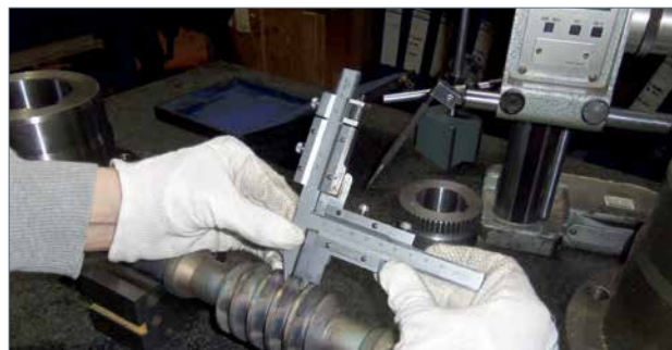
Размеры зубьев передачи проверяются нониусным штангензубомером.
