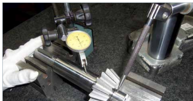
Проверка соосности при помощи индикатора с круговой шкалой.
